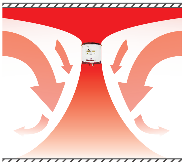
Dystrybucja ciepła z destratyfikatorem Maximizor
